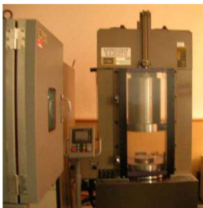
图 1 MTS 815.04 电液伺服可控制刚性试验机
